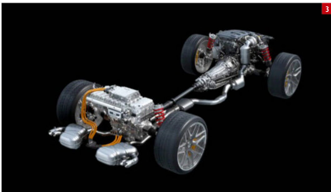
1 De tweeklaps versnellingsbak is een dog-box en heeft geen synchromeshringen; door de elektromotor nauwkeurig aan te sturen is kraakvrij schakelen toch mogelijk. 2 De Electric Drive Unit op de achteras moet een betere gewichtsverdeling opleveren. 3 De viercilinder levert samen met de elektromotor meer dan 650 pk, da's beduidend meer dan de 510 pk van de 4.0 V8 die tot voor kort in de C 63 S AMG is gebruikt. 4 Op het asje tussen het compressorwiel en het turbinewiel zit een elektromotor, die de turbo razendsnel op tempo kan brengen en, minstens zo interessant, ook op tempo kan houden om de boel op druk te houden voor een directe respons wanneer je je voet van het gaspedaal haalt. 5 De tweeliter viercilinder uit de A45 AMG maakt een draai in lengterichting en pikt dankzij de elektrische turbo bij 450 pk.
